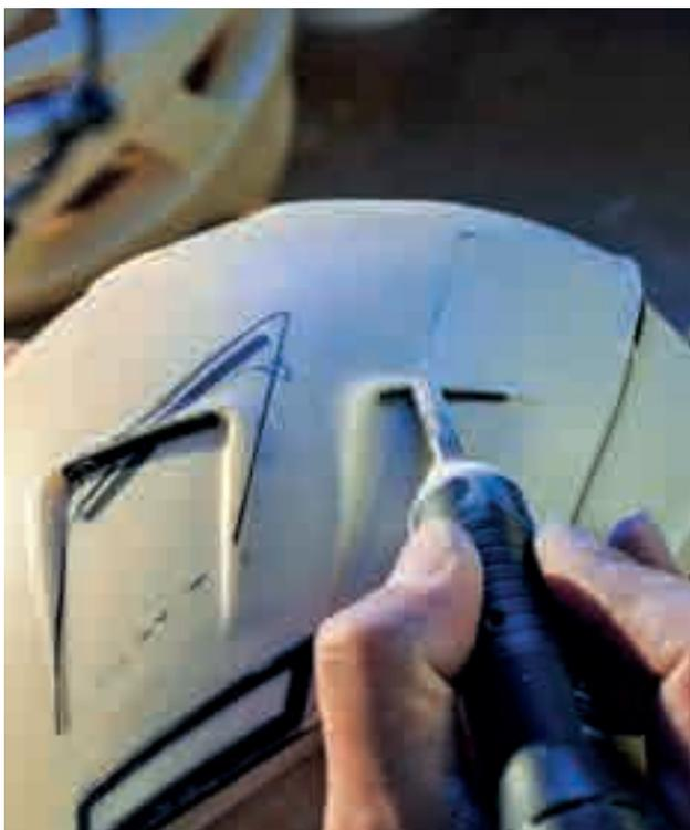
Wir produzieren unsere Helme und Brillen in den eigenen Werken in Lederdorn und Passau. Dort werden anhand der CAD-Daten Werkzeuge für den neuen Helm hergestellt. Der Helm durchläuft einige Produktionsschritte bis zu seinem Endstadium: Vom Tiefziehen, Fräsen, Schäumen, bis hin zum Bekleben und Ausstatten mit Gurtbändern und Pads. Auf dem hauseigenen Prüfstand durchläuft jedes Modell diverse Schlag-, Abstreif- und Zugtests, um das Prüfsiegel nach gültiger EN-1077 Norm zu erhalten.
